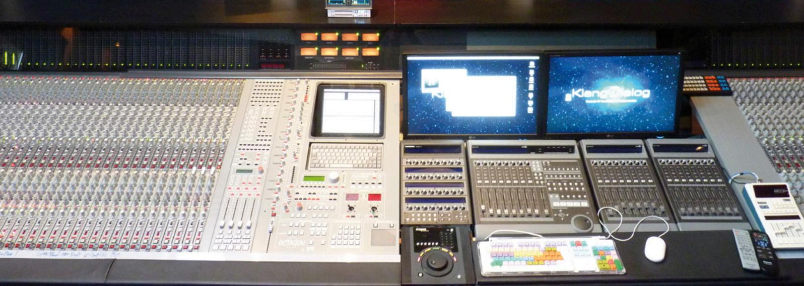
Die Pultaufsicht zeigt den Controller-Einbau mit zwei integrierten 24-Zoll-Schirmen an der Hörposition
