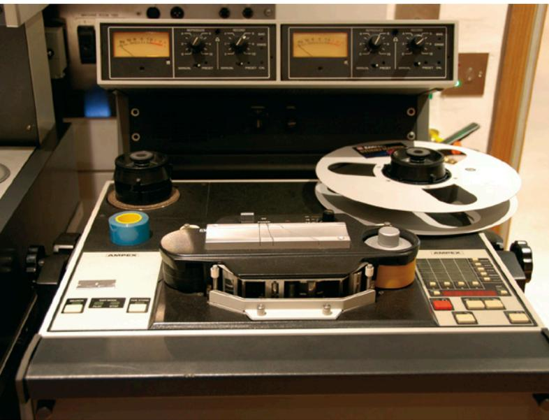
Ampex Stereomaschine mit 1“ Kopf
