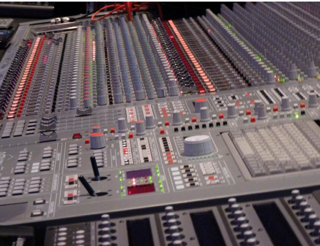
Das D&R Octagon verfügt über alle Funktionen, die ein Arbeiten mit Surround-Formaten erfordert. Dazu gehören auch automatisierte Joystick-Panner (vorne Mitte)
