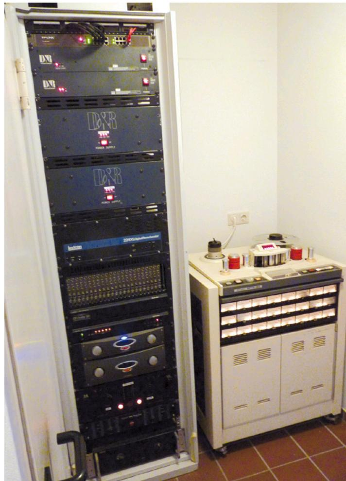
Der Maschinenraum mit Otari MTR-90 24-Spur-Maschine: Im Rack erkennt man die Pultnetzteile, das Lexicon 224XL (Blue Top, allerdings mit LARC Fernbedienung) und das 24ch Dolby SR
