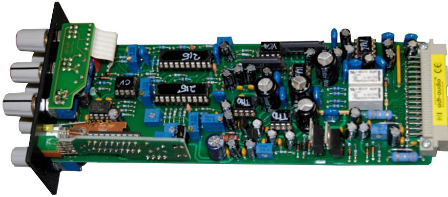
Beispiel für die Bauform eines ToolMod-Moduls
