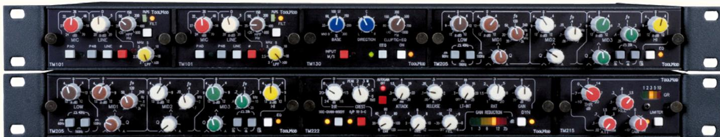
Typische ToolMod-Kombinationen: PreAmps mit Basisbreitenregelung, M/S-Funktionalität und EQ (oben) und EQ/Kompressor-Limiter
