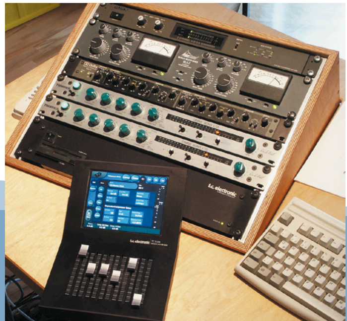
Von oben nach unten: Prismsound MLA-2, zwei Crane Song Trakker als Stereopaar und die TC-Icon-Fernbedienung mit Prozessoreinheit, auf der gerade die MD3-Software läuft
