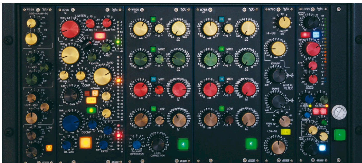
Unser 19-Zoll-Mastering-Frame mit Sidechain-Kompressor, 8-Band-EQ, Niveau-Filter und Delay-Limiter
