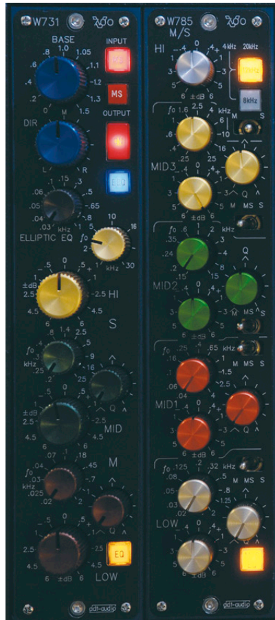
Mastering-M/S-EQ-Zentrale mit Richtungsmischer
