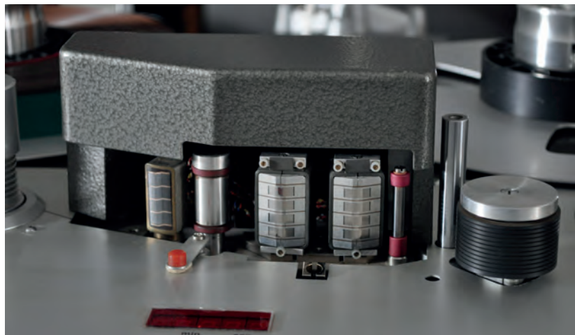
Köpfe auf einer M15A Quadromaschine. Deutlich sind die 4 Spuren auf einer Breite von 1-Zoll erkennbar
