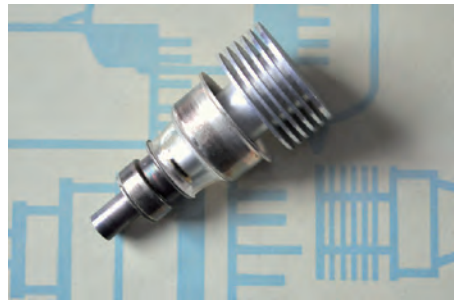
Scheibentriode für den SHF-Bereich bis 3 GHz
