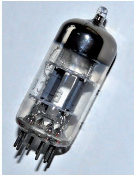
ECC81 – zwei Trioden-Systeme in einem Kolben
