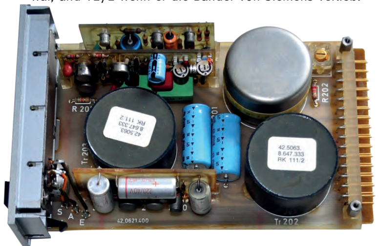
V672, der „Transistor-V72“ von Telefunken (Innenansicht)
