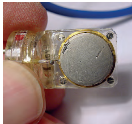
Auf keinen Fall so! Folgen einer unsachgemäßen Reinigung
