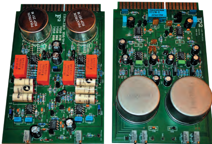
Entzerrer- und Ausgangsverstärkerplatinen
