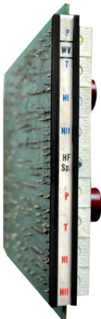
Wiedergabeverstärker mit Abgleichtrimmern
