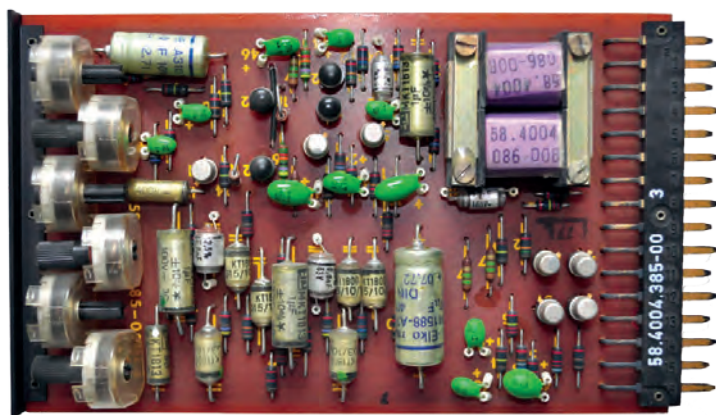
Wiedergabe-Verstärker einer M5c mit diskreten Bauteilen
