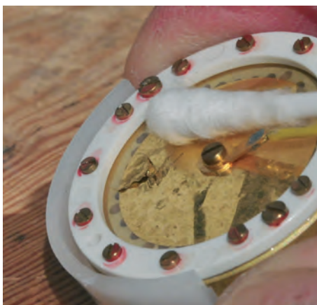
Auf keinen Fall so! Folgen einer unsachgemäßen Reinigung
