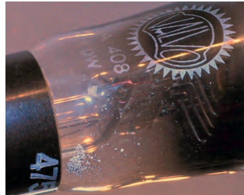
Neue Röhre, deren Kathodenschicht abgefallen ist
