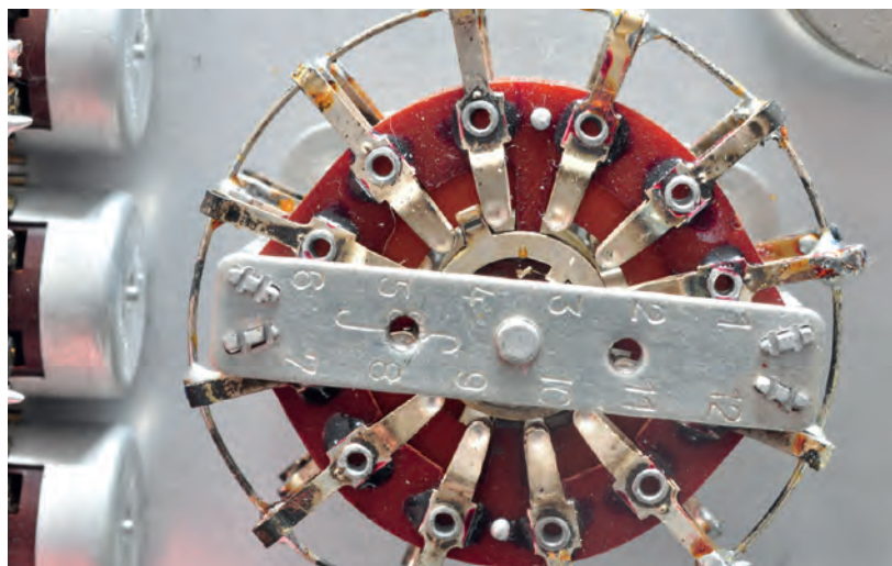
Preiswerter Schalter mit Kontaktebenen aus Pressstoff
