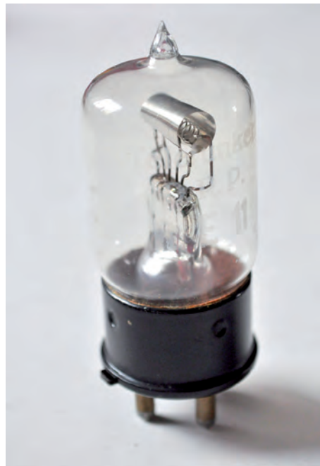
Foto RE 11 – erste in Serie hergestellte Telefunken-Röhre
