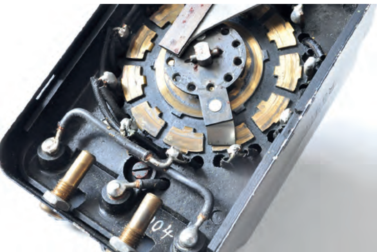
Rastschalter mit selbstreinigenden Kontakten
