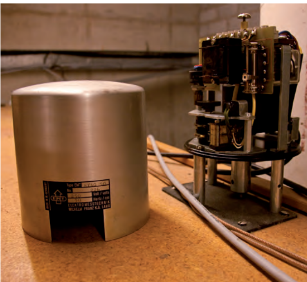
Der Antriebsmotor in geöffnetem Zustand, der für die Bedämpfung der Platte sorgt
