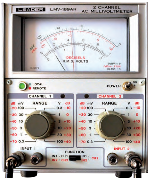
Doppelinstrument für die Pegelung von Stereogeräten
