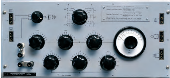
Induktivitätsmessbrücke für die Übertragermessung
