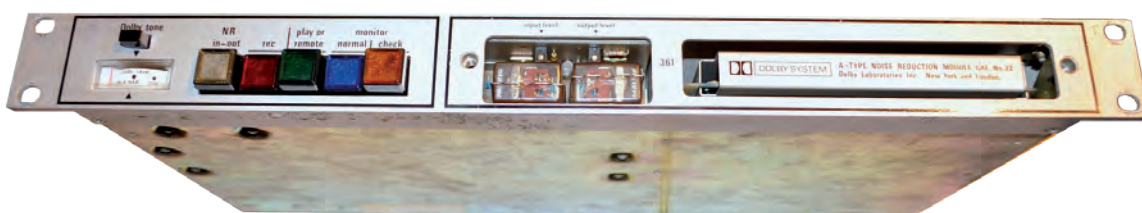
Dolby-Kompaner A 361 mit eingesteckter A-Platine
