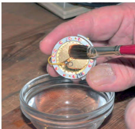
Reinigung der Membran-Oberfläche mit destilliertem Wasser
