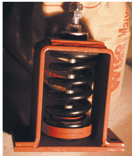
Schwingungsabhänger für schwere Lasten von 750 kg, abstimbar bis 1.5 Hz
