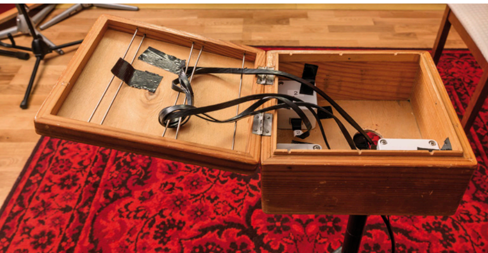
Abbildung 1 (links): Die drei Magnetfeldsonden, angeordnet für die drei Raumachsen und untergebracht in einer Zigarrenkiste
