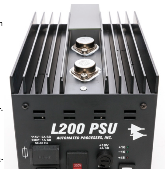
Abbildung 5: Das API L200 in der klassischen Version lässt sich an den zwei Transistoren auf dem Kühlkörper erkennen
