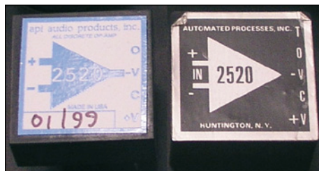
Abbildung 6: Der seit Jahren von API gebaute und verbaute diskrete OpAmp 2520
