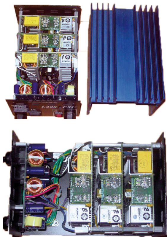
Abbildung 2: Das API L200 in der Version als Schaltnetzteil, Foto: Volker Mayer
