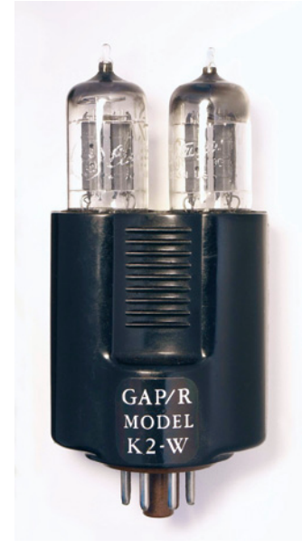
Abbildung 5: K2-W – ein Operationsverstärker mit zwei 12AX7 Röhren aus dem Jahr 1952
