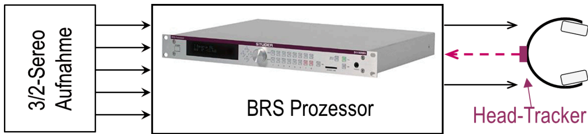
Abb. 7: Prinzip des ‚Binaural Room Synthesis‘ (BRS) Verfahrens. Der Prozessor faltet gespeicherte binaurale Raumimpulsantworten, die Auswahl geschieht in Abhängigkeit von der Kopfausrichtung. Die Wiedergabe kann bei Bedarf mit einem Subwoofer für Tieftoneffekte ( < 60 Hz) ergänzt werden
