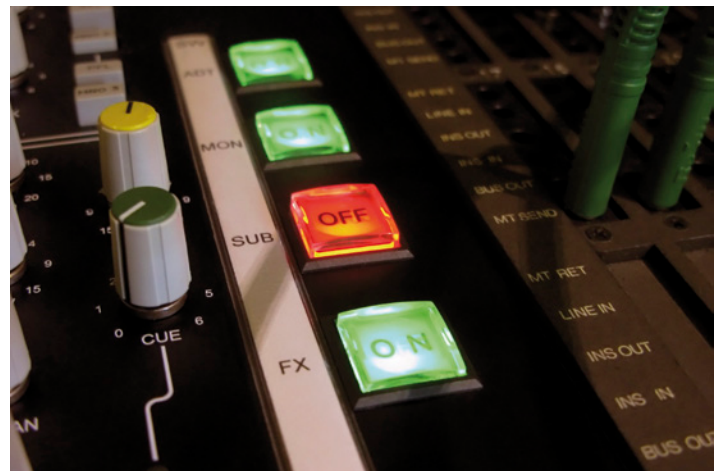
Relaisgesteuerte Schaltung der einzelnen Stromkreise vom Pult
