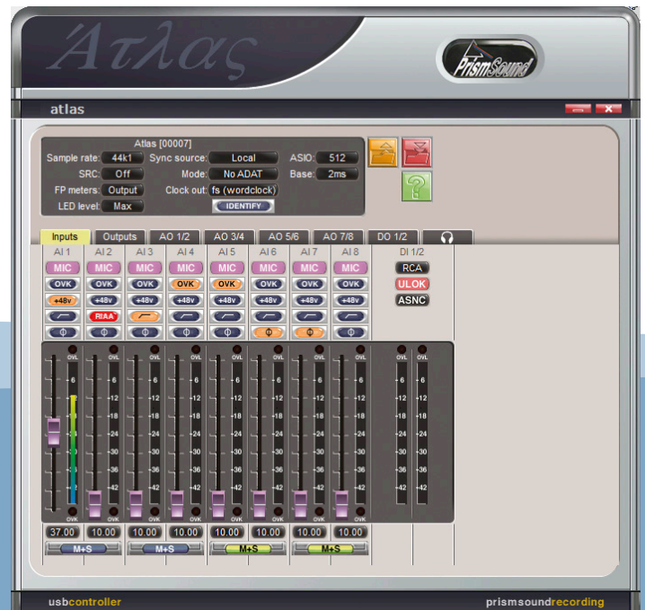
Auf der Inputs-Seite werden die Mikrofonvorverstärker und all ihr Zubehör parametrierbar
