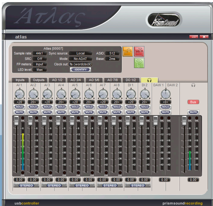
Die Routingseiten gleichen einem klassischen Mischpult mit verschiedenen Ausgängen
