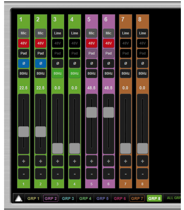
Mikrofonvorverstärker-Seite mit gruppierten Kanälen (farblich hinterlegt)
