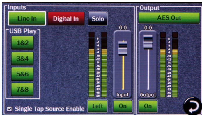
Routing Page: Links alle Eingänge, rechts der gerade gewählte Ausgang zur Eingangszuordnung inklusive Pegel
