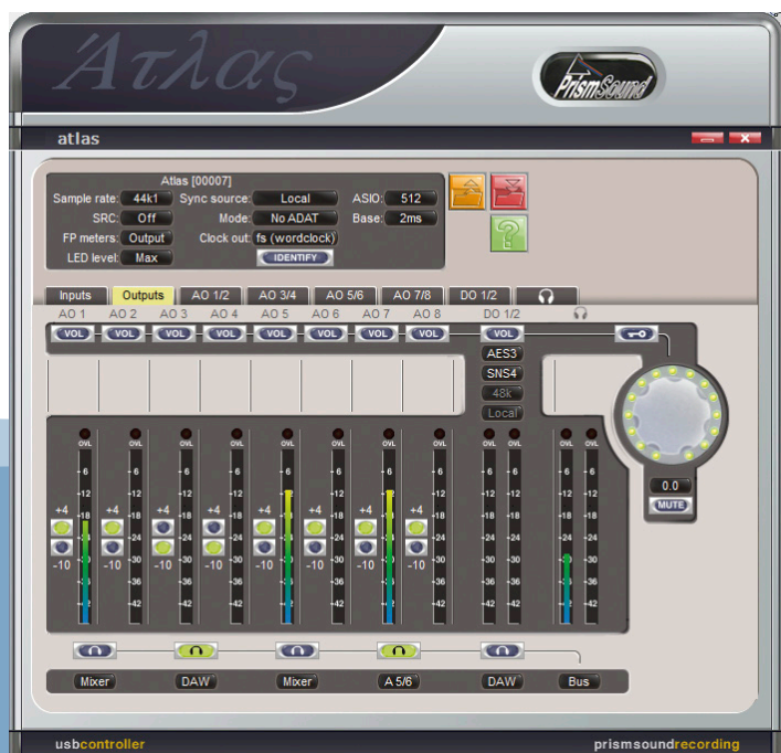
Alle Ausgänge können mit dem Drehgeber verknüpft werden und stehen so, z.B. als Monitorweg im direkten Zugriff
