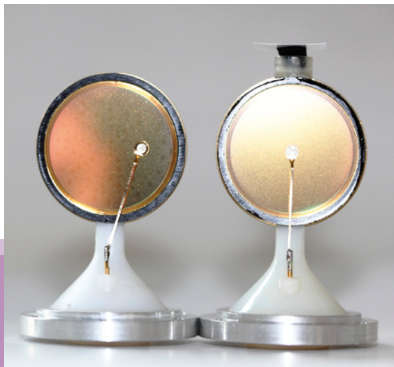
Abbildung 4: asymmetrisch und symmetrisch kontaktierte M71 PET Großmembranen
