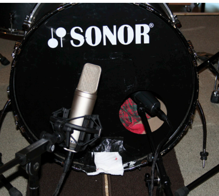
Abbildung 7: Werden mehrere Mikrofone für eine Quelle genutzt, kommt es zu Laufzeitdifferenzen
