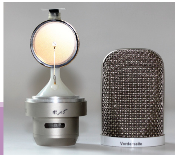
Abbildung 5: symmetrisch kontaktierte M71 PVC Großmembran mit Schutzkorb
